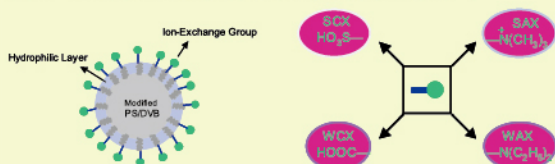
图1. Proteomix离子交换相的化学结构示意图
